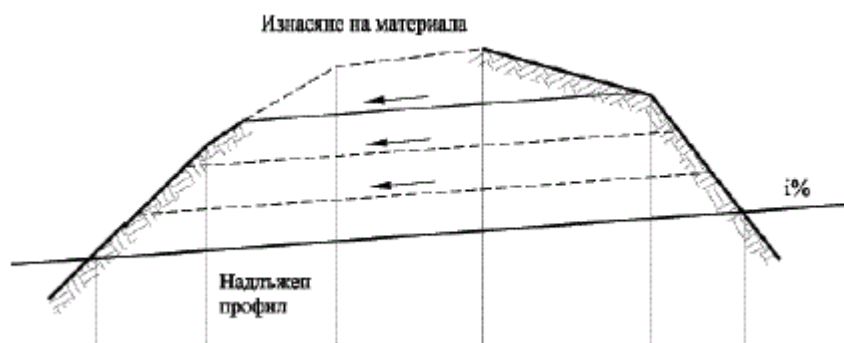
Фигура 141. Отводняване на изкоп в надлъжно направление
