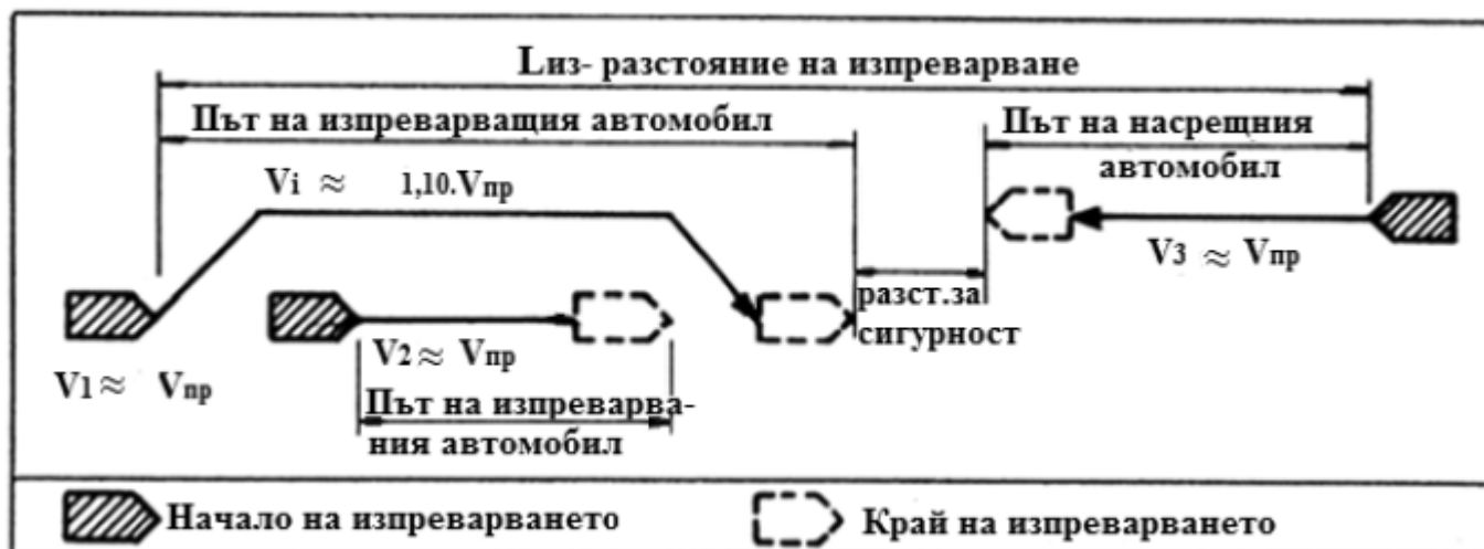
Фигура 9.2. Модел на изпреварване
