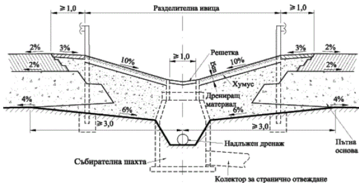
Фигура 135. Отводняване на разделителна ивица на път в прав участък
