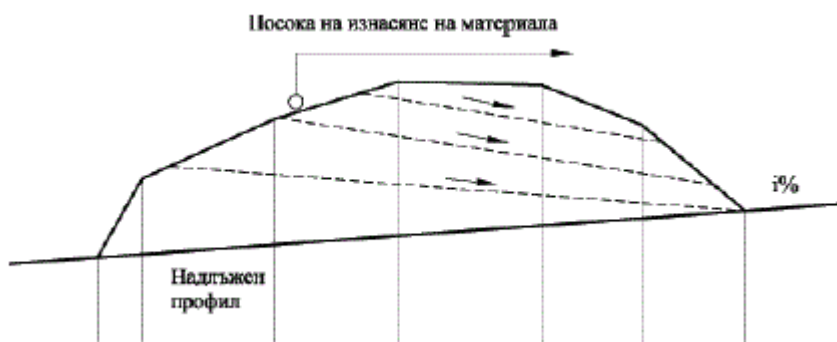
Фигура 141. Отводняване на изкоп в надлъжно направление
