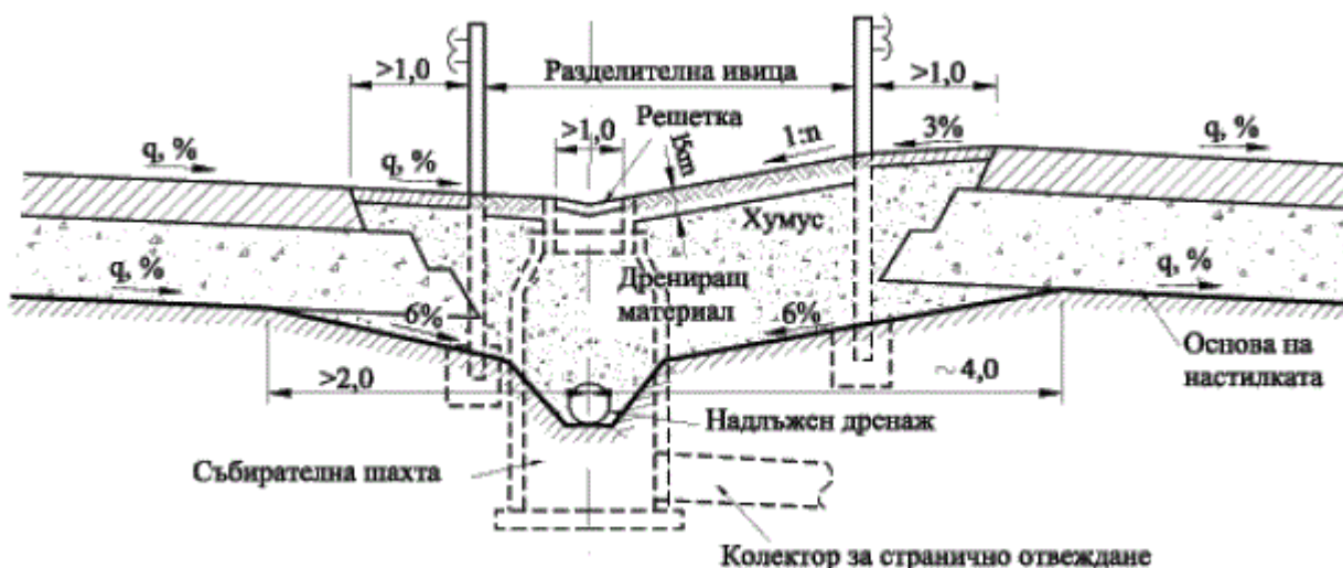
Фигура 135. Отводняване на разделителна ивица на път в прав участък
