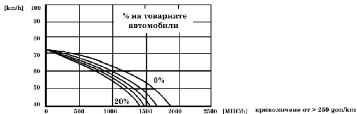
Фигура 11.5. Графики за определяне скоростта на леките автомобили при двулентови пътища
