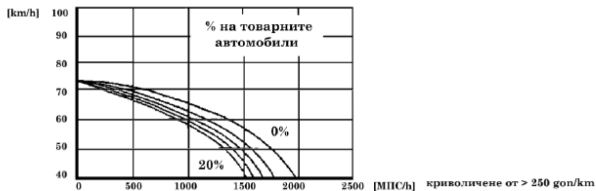
Фигура 11.4. Графики за определяне скоростта на леките автомобили при двулентови пътища
